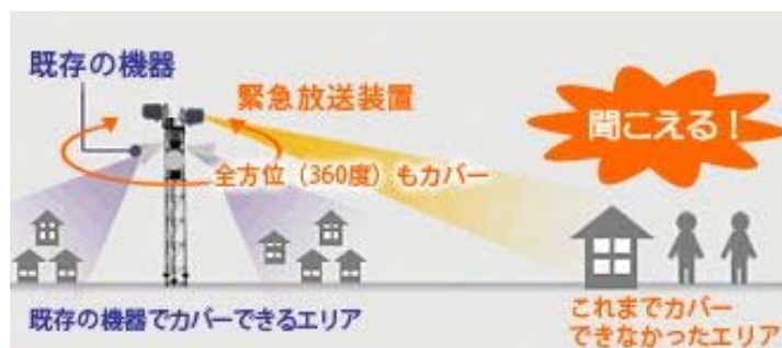
図－5.4.6 全方位スピーカーの効果 ( http://www.towaeng.co.jp/solution/emg/lrad/index.html より)
