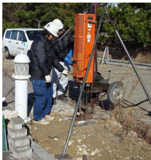
写真-3.3.1 動的コーン貫入試験の作業の様子
