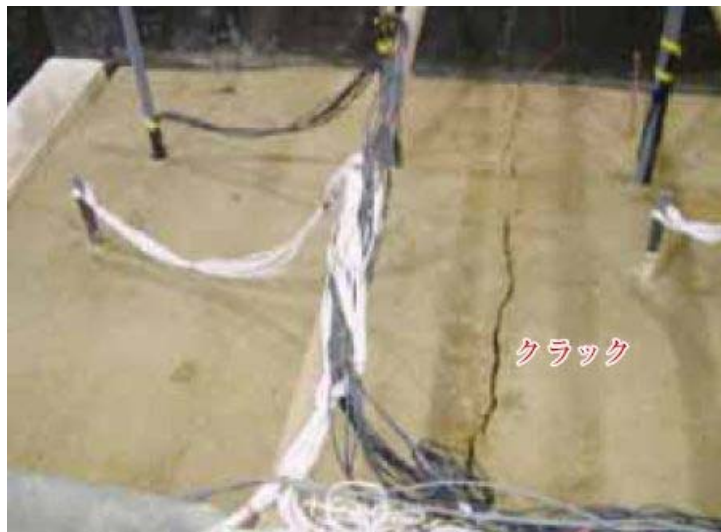
写真-4.1.4 水平層状排水盛土の地表面クラック
