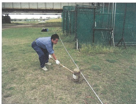
写真－2.4.1 測定の様子(起振)
