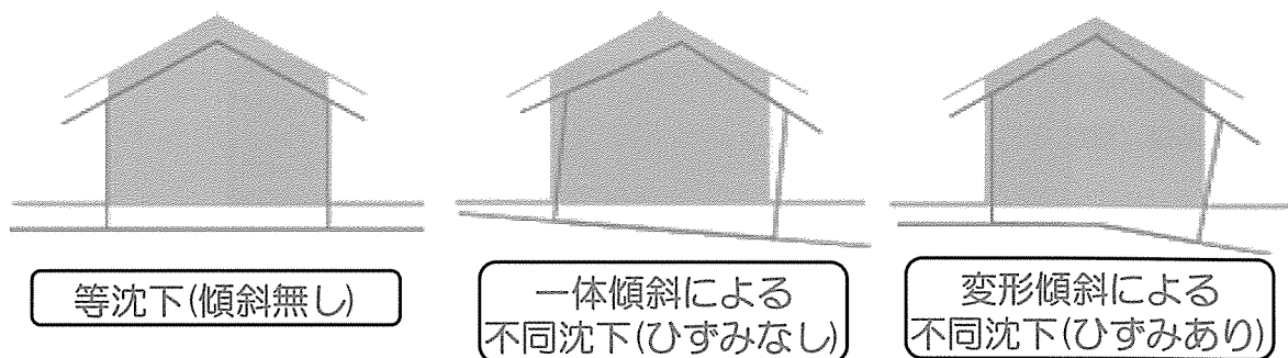
図-3.3.1 建物の沈下の種類
