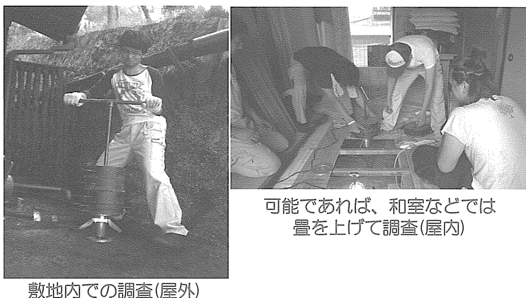
写真-3.3.9 スウェーデン式サウンディング試験の様子
