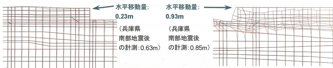
図-3.4.18 内護岸部の変形図（解析終了時(250 秒後)、黒線：変形前、赤線：変形後）
