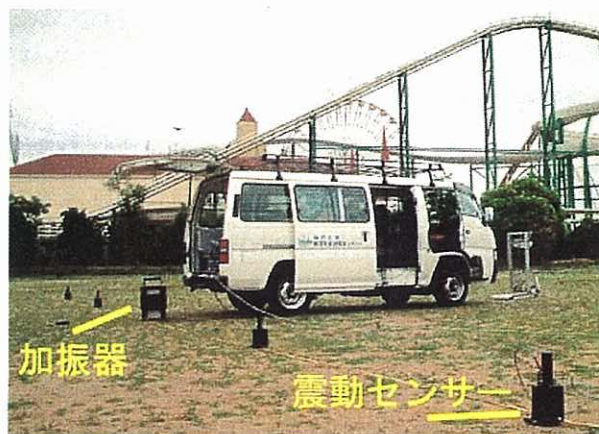
図-2.4.2 現場での SASW 試験法の概要
